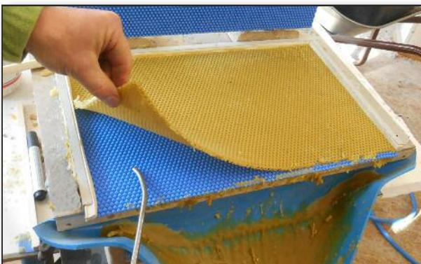
Mit etwas Übung und der geschickten Gabe von Druckluft, baut sich ein Luftpolster zwischen fertiger Mittelwand und Matrize auf. Die Entnahme ist nun ein Kinderspiel.
