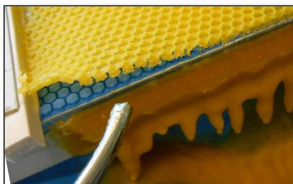
Nach dem Abschaben mit dem Stockmeisel empfehlen wir mittels einer Pressluftpistole die Mittelwand kurz anzulupfen um sie dann unter Druckluft als ganzes aus der Form zu nehmen.
