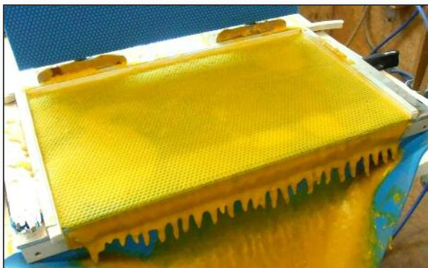
Alle uns bekannten Mittelwandpressen sind so konstruiert, dass die Matrizen vorne auf Kante mit der Presse abschließen bzw. abgeschnitten wurden. Deckel und Boden bilden beim Verschluss eine gerade Kante.
