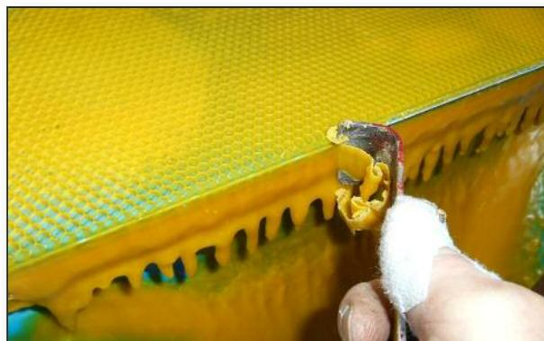
Die Beschneidung der Mittelwand in der Presse hat viele Vorteile. So ermöglicht dieser Arbeitsschritt die fertige Mittelwand exakt abzukanten. In der Regel wird dazu der Stockmeisel benutzt um einem glatten Schnitt zu erreichen. In der Praxis ist das aber nicht immer ein glatter Schnitt, weil das Wachs noch warm ist und sich etwas ziehen lässt. Diese Lösung des Zuschnittes hat sich im Laufe der Jahre durchgesetzt – auch deshalb weil es keine Alternative gab..
