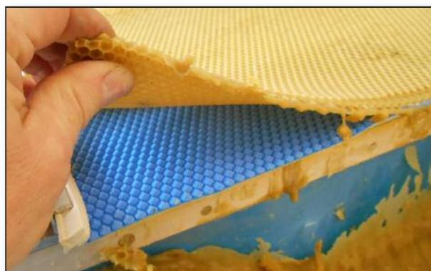
Dieses Foto zeigt die althergebrachte Methode der Entnahme vom Mittelwänden aus der Presse. Hier durch das Hochheben an der Seite und dem Abheben der erkalteten Mittelwand aus der Silikon-Form. Diese Art der Entnahme ohne Hilfsmittel wie z.B. mit Druckluft, dauert in der Regel etwas länger – auch weil der zusätzliche Abkühleffekt durch die Pressluft fehlt.
